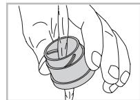
In caso di sporco particolare (per esempio sabbia) la conchiglia oculare è completamente svitabile e può essere pulita facilmente.
