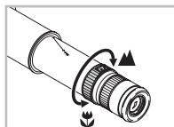
Terävyttä säädetään säättörengasta pyörittämällä, jolloin okulaariputki liikkuu suuntaan tai toiseen.
