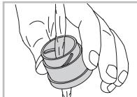
Bei starker Verschmutzung (z. B. Sand) ist die Drehhaugenmuschel komplett abschraubar und somit einfach zu reinigen.
