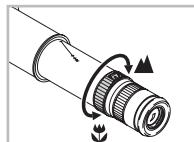
De scherpstelling vindt plaats door draaien van de stelring, waarbij de uitbrekbare buis en het oculair mee bewegen.
