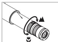
Skapheden indstilles ved at dreje på indstillingsringen, hvorefter trækrøret og okularet også bevæges.
