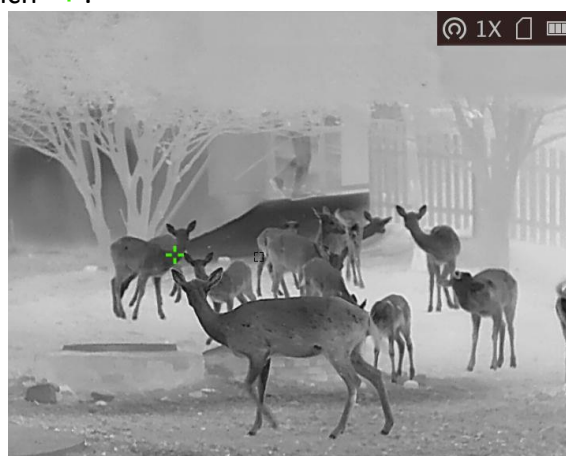
Abbildung 5-3 Stelle mit höchster Temperatur verfolgen
