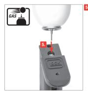
Halten Sie das Magazin mit Gastank nach unten geneigt. Stecken Sie die Gasflasche senkrecht in die Einfüllöffnung des Magazins. Drücken Sie die Gasflasche in die Einfüllöffnung. Wenn Gas aus der Einfüllöffnung entweicht, ist das Magazin mit Gas gefüllt.
