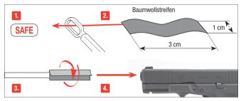
Sichern Sie die Airsoft Waffe. Nehmen Sie einen ca. 30 cm dünnen, langen Stab. Wickeln Sie ein Stück Baumwolltuch um das Ende, benetzen Sie das Tuch mit etwas Waffen-Öl und reinigen Sie damit den Lauf.
