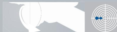
Para mover el punto de impacto **hacia la derecha**, gire el elemento de control de la torreta de ajuste horizontal en la dirección de la flecha «R» (derecha).
