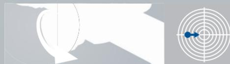
pohyb středního bodu zásahu **doprava** – otočte ovladačem točítka stranové korekce ve směru šipky „R“
