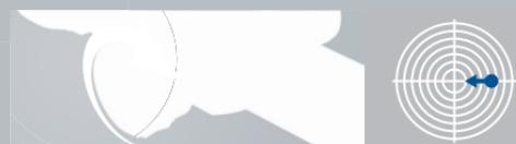
Para mover o ponto de impacte **para a esquerda**, afaste o botão de ajuste horizontal da seta "R".
