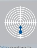
Per spostare il punto di mira centrale **verso l'alto** ruotare la torretta di regolazione verticale nella direzione della freccia "UP" (SU).
