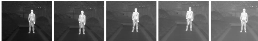
Abbildung 3-2 Einstellen der Helligkeit im Modus Weißglühend
