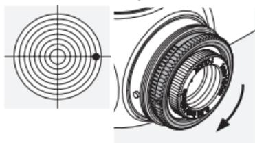
Tournez la bague moletée extérieure de la tourelle latérale dans le sens inverse de la flèche R (sens des aiguilles d'une montre).
