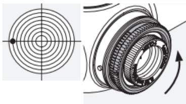
Поверните внешнее рифленое кольцо на боковой турели в направлении R (против часовой стрелки).
