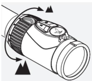
La anilla de ajuste de aumentos tiene un rango de giro de 180° para obtener el aumento deseado. El ajuste es continuo. La escala de la anilla de ajuste permite conocer en todo momento el nivel de aumento.
