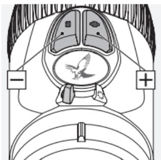
Du kan nu reglera ljusstyrkan i det valda läget med hjälp av knapparna + och -. För att snabbt hitta rätt ljusstyrka kan du hålla aktuell knapp intryckt (lång puls). Om du vill finjustera trycker du en gång på knappen (enstaka puls).
