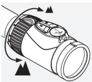
Tournez la bague de réglage du grossissement sur 180°, jusqu'à obtenir le grossissement souhaité. Le réglage est continu. Les graduations présentes sur la bague de réglage per-
