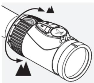
Haluttu suurennus saadaan kääntämällä suurennuksen säätörengasta korkeintaan 180 astetta. Säätö on portaaton. Säätörengaan asteikko helpottaa asetuksen hahmottamista. Karhen-
