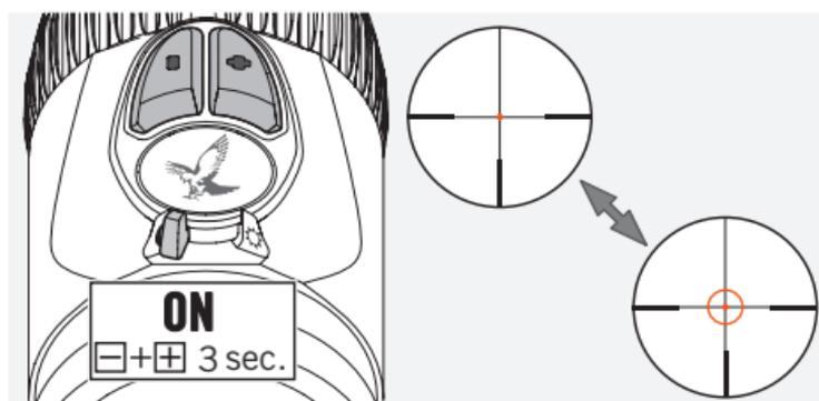
Kytke FLEXCHANGE 4A-IF -ristikon valaistu rengas käyttöön kääntämällä POIS/PÄIVÄ/YÖ-kytkin PÄIVÄ- tai YÖ-asentoon. Ristikon valaistus on nyt aktivoitu. Kytke valaistu rengas käyttöön painamalla painikkeita +/- samaan aikaan kolmen sekunnin ajan. Kytke rengas pois käytöstä toistamalla tämä vaihe.
