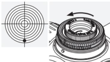
Поверните внешнее рифленое кольцо на верхней турели в направлении H (против часовой стрелки).
