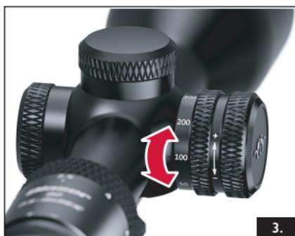
Кольцо отстройки от параллакса фиксируется в положении 100 м. Здесь оптический прицел ведет себя как прицел с оптикой, выверенной на 100 м. Отметки на кольце отстройки от параллакса приблизительно соответствуют ожидаемому расстоянию, но являются лишь вспомогательным ориентиром. Точная настройка должна производиться по наилучшей резкости изображения при максимальной кратности на соответствующую дистанцию выстрела.
